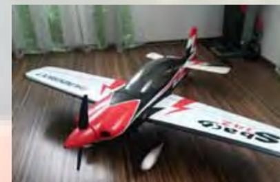
Das Bild zeigt die Sbach von Günter. Ein Modell der Kategorie Kunstflugmitteldecker aus Elapor (EPO). Elapor ist ein aus kleinen Kugeln expandierter Hartschaum, der zäher als Styropor ist und sich daher besonders für die Formgebung im Modellbau eignet.
